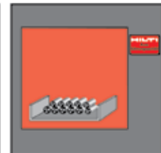
4. Fixez la plaque signalétique (au besoin).
