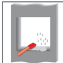
1. Nettoyez la pénétration. Pré-humidifiez les côtés de la pénétration.
