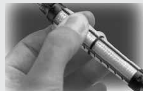
Étape 2 : Percer l'extrémité de la passoire à l'aide de la tige servant à vérifier la profondeur d'ancrage.
