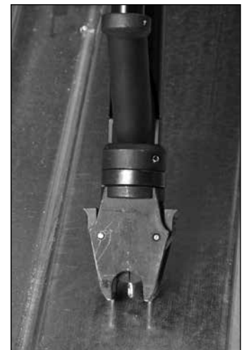
Embout du SDT 5 après la première compression : l'outil est chargé et prêt à couturer les panneaux.
