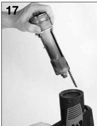
17 Introduire le manchon de piston dans l'outil.
