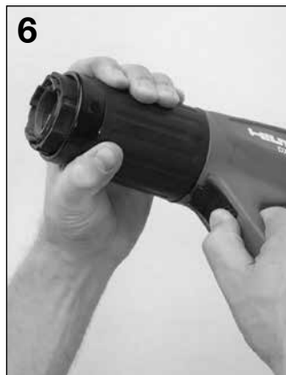
6 Retirer le manchon de piston du dispositif de rappel à gaz en appuyant sur le bouton de blocage situé à l'avant de la poignée.
