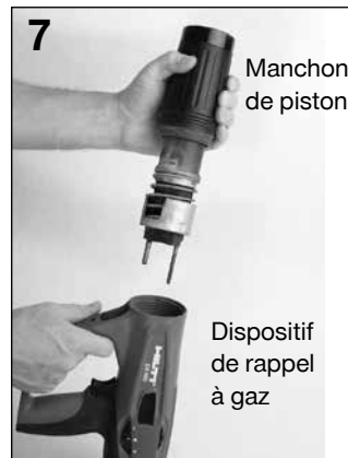
7 Dévisser le manchon de piston du dispositif de rappel à gaz.
