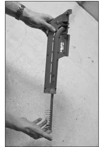
Pour retirer les fixateurs, introduire une bande plastique dans le chargeur et retourner celui-ci.
