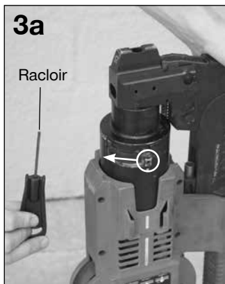
Tourner le levier afin de dégager le cliquet.
