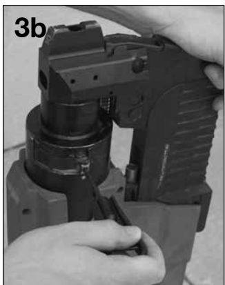
Outil coincé en position comprimée.
