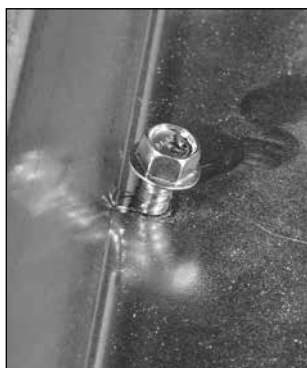
Saillie du fixateur : Le réglage du couple est trop bas. L'augmenter d'une position et poser un autre fixateur.
