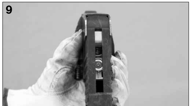
9 Une bande reste bloquée dans l'embase.
