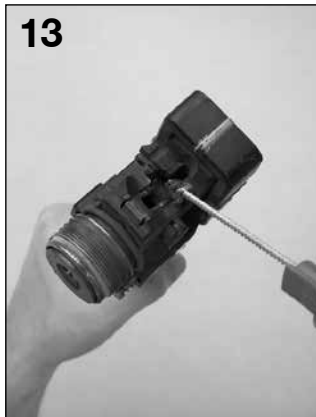
13 S'assurer que le guide-fixateur est nettoyé à fond.
