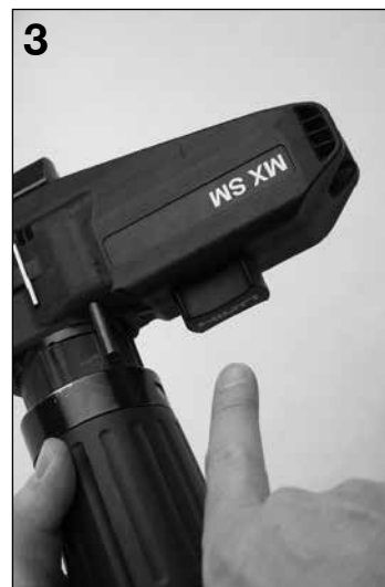
3 Régler la manette parallèlement au chargeur afin de tenir en place les fixateurs.
