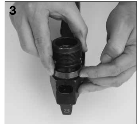
3 Poser le dispositif de retenue par-dessus le montage.
