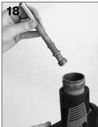
18 Introduire le piston dans l'outil.
