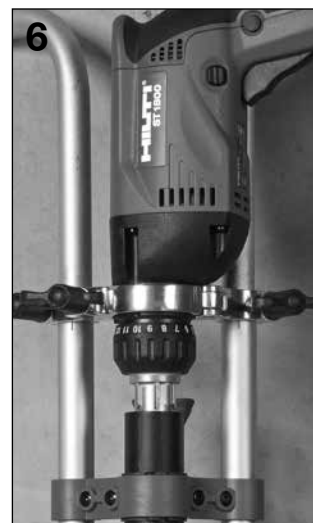
6 Refermer le collier et fixer l'outil en place en serrant l'attache papillon.
