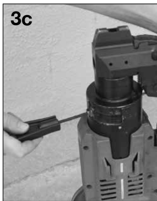
Tourner le levier afin de dégager le cliquet.
