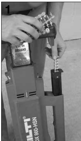
1 Introduire les fixateurs dans le chargeur.
