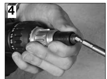
Insérer l'arbre d'entraînement avec l'embout dans la ST 1800.
