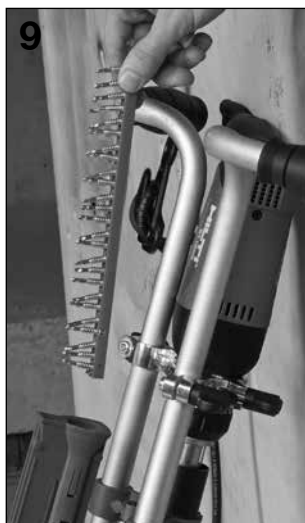
9 Charger jusqu'à 50 fixateurs dans le chargeur.
