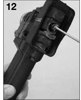
12 Brosser l'intérieur du guide-fixateur.
