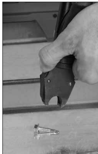
Pour dégager l'embout, comprimer les deux côtés.
