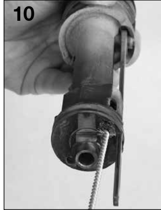
10 Brosser l'orifice du réglage de puissance.
