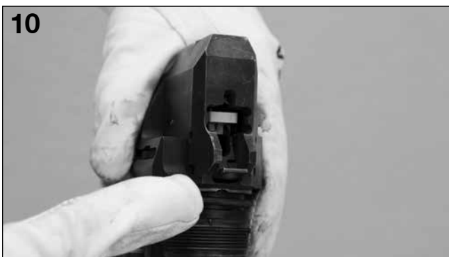
10 Appuyer sur la manette afin de retirer les fixateurs.
