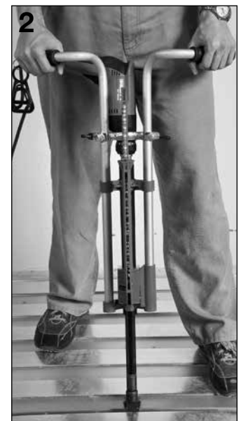
Adapter la hauteur des poignées à la taille de l'opérateur.
