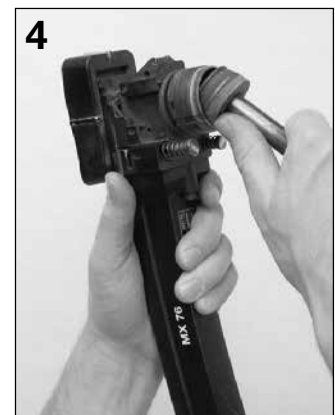
Retirer la bague d'arrêt.
