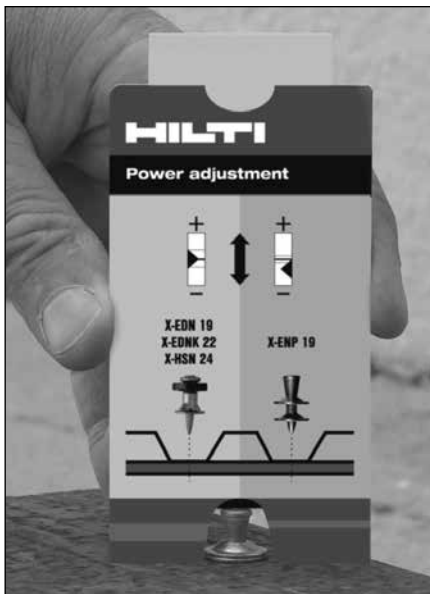
Fixateur X-ENP-19 sous-enfoncé (le guide s'arrête dans la zone rouge – réglage de la puissance nécessaire)
