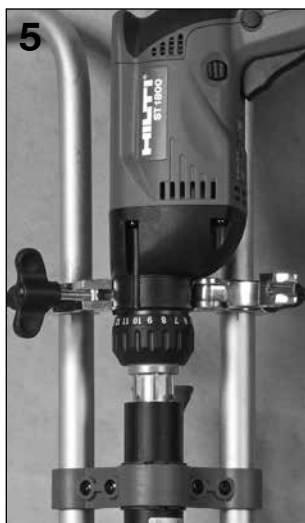
5 Glisser l'arbre d'entraînement avec l'embout dans le manchon et installer la ST 1800 dans le châssis.
