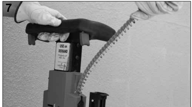
7 Tirer les cartouches hors de l'outil à l'autre extrémité.
