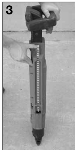
3 S'assurer que l'extrémité de la bande affleure.
