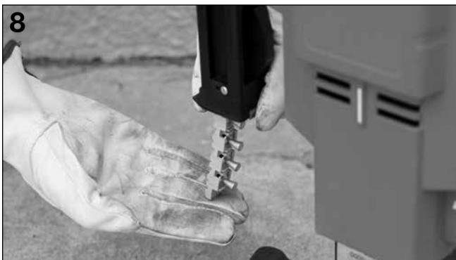
8 Retirer les fixateurs du chargeur.
