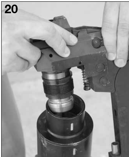
20 Réintroduire l'embase et la visser en place.
