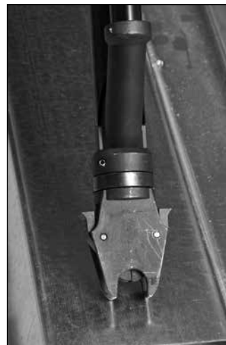
Embout du SDT 5 avant la première compression : aucune vis n'est présente dans la chambre de vissage.
