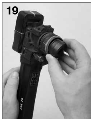
19 Réintroduire la bague d'arrêt dans le chargeur.
