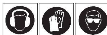
Llevar siempre gafas protectoras Llevar siempre guantes protectores Protejese siempre los oídos
