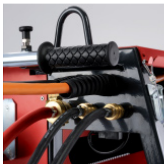
Vandtilslutning til motorenheden
