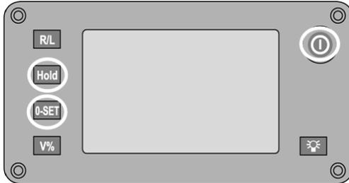
Drücken Sie die Taste **Hold** und die Taste **0-Set** gleichzeitig und halten Sie diese gedrückt. Drücken Sie zusätzlich die Einschalttaste und lassen Sie diese erst los bis auf der Anzeige alle Segmente zu sehen sind.
