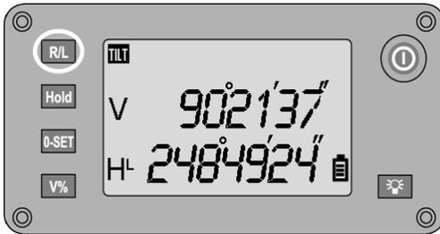
Die Messrichtung für die horizontale Winkelmessung kann durch Drücken der **Taste R/L** zwischen Rechts - im Uhrzeigersinn und Links - im Gegenuhrzeigersinn geändert werden.
